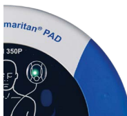
Figur 11. Blinkande grön LED: ingen åtgärd behövs.
